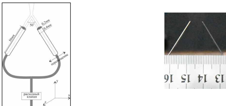
Рис. 21. Схема расположения микросопел (слева) и фотография (справа).
